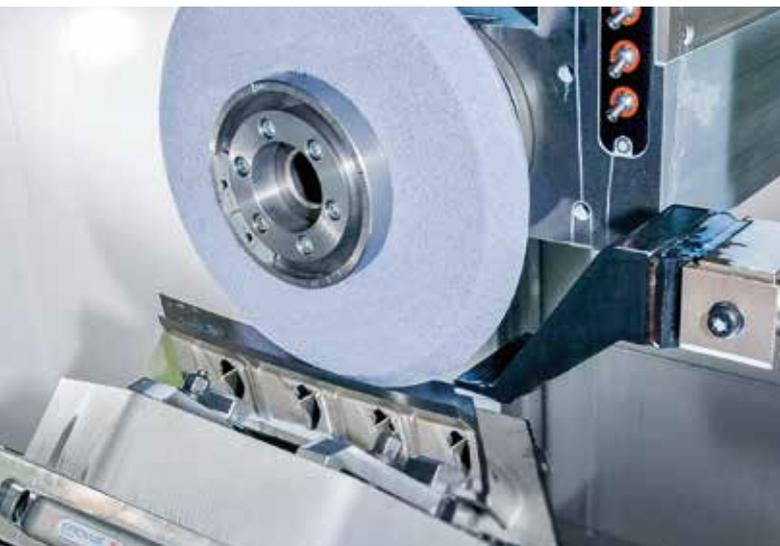
Die NC-Steuerungen der MÄGERLE Schleifzentren ermöglichen eine exakte Positionierung der Kühlmittelzuführung unter Einbezug der jeweiligen Schleifscheibengeometrie. Sperrluftbeaufschlagte Labyrinthdichtungen schützen sämtliche Lagerungen innerhalb des Bearbeitungsraums vor Verschmutzungen und tragen zur hohen Lebensdauer des Gesamtsystems bei.
