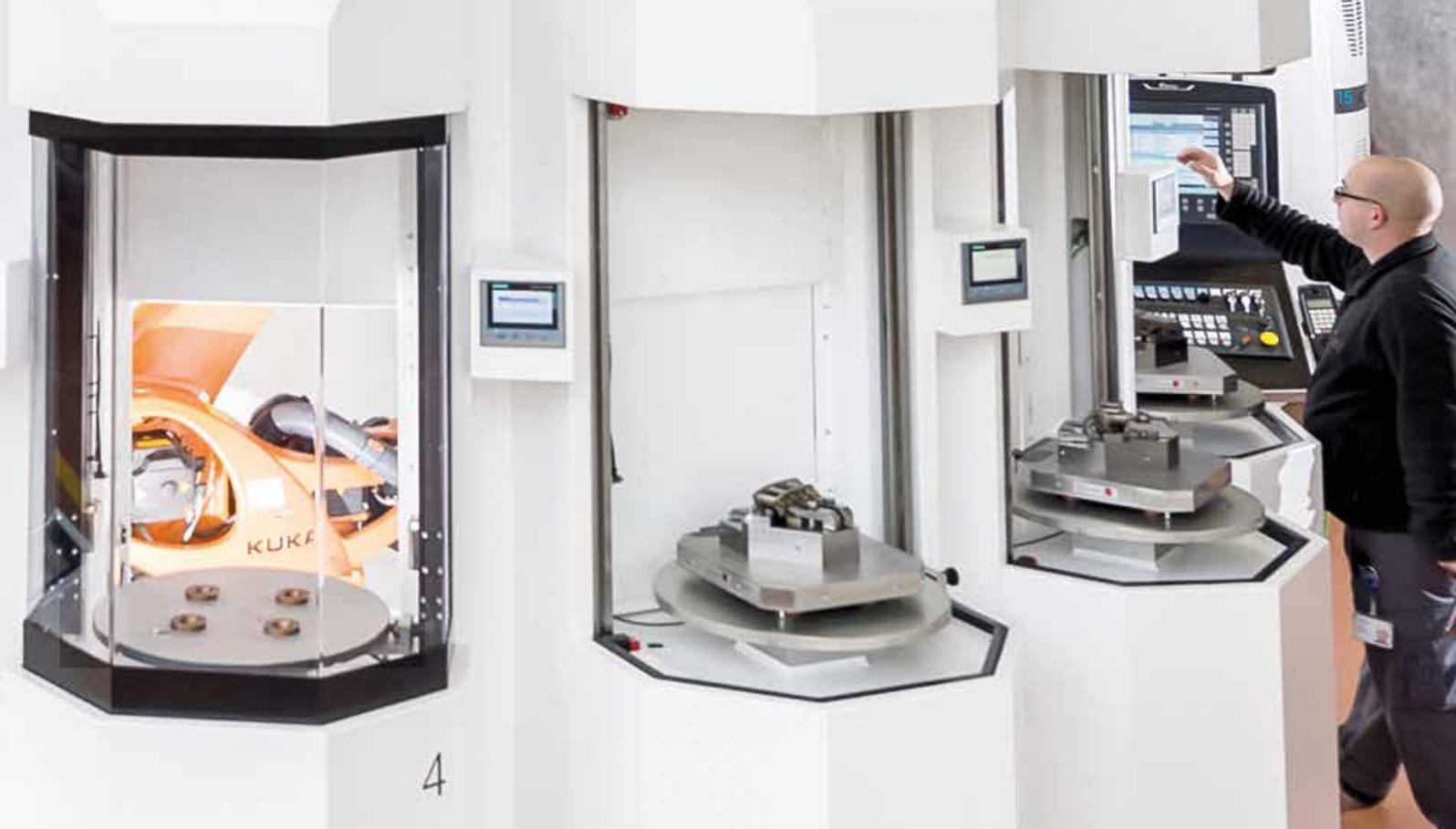
Die Beladung der Werkstücke erfolgt über ergonomisch und zum Arbeitsbereich abgetrennte Ladestationen.
