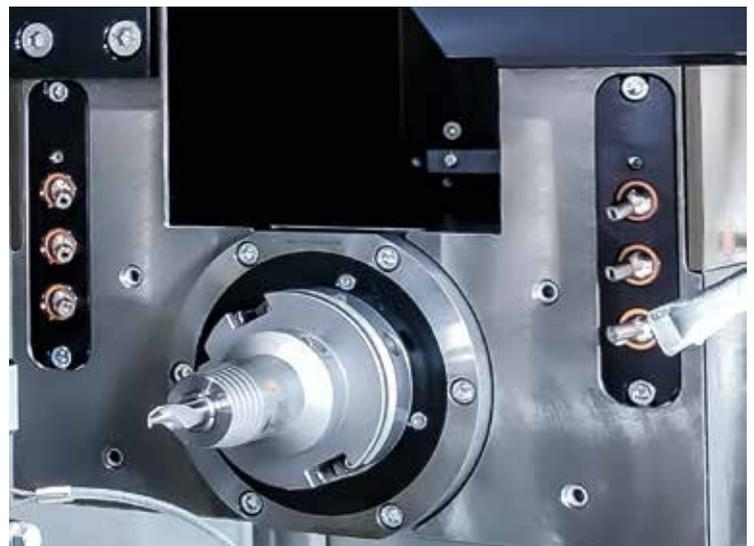
Für Bohr- und Fräswerkzeuge stehen Düsen am Schleifsupport und optional eine Kühlmittelzufuhr durch die Spindel zur Verfügung.
